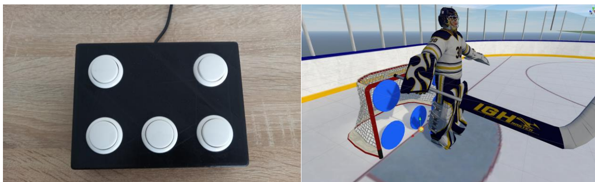
Figure 1. À gauche, boîtier réponse équipé de cinq touches disposées de manière identique aux différentes cibles du goal. À droite, présence de « l'origine » (point jaune), c'est-à-dire le point de référence pour chaque position ou déplacement du joueur ou du gardien.
